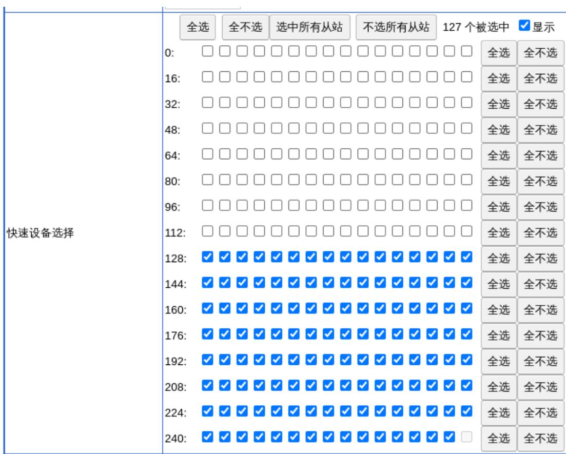
图 15: 选择MS/TP 总线上的快速设备
